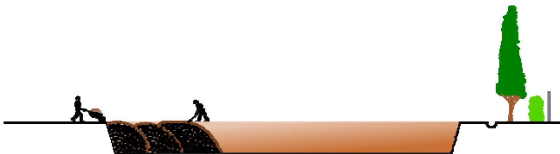
Figura 38. Perfil e corte esquemático da cobertura diária dos resíduos.
