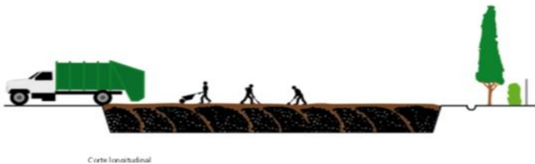
Figura 43 – Execução da camada de cobertura final da vala.
