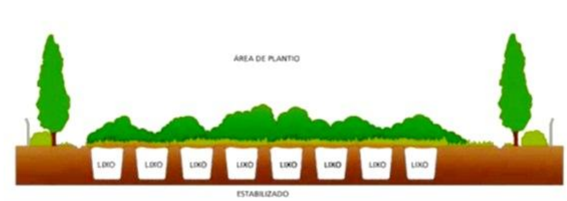
Figura 45. Perfil e corte esquemático do aterro em valas finalizado.
