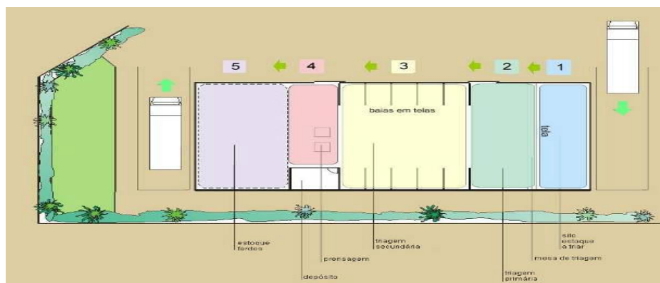
Figura 13 – Etapas de trabalho no galpão de triagem
